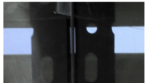
図 3 単スリットにシャープペンの芯を置いて作った複スリット
