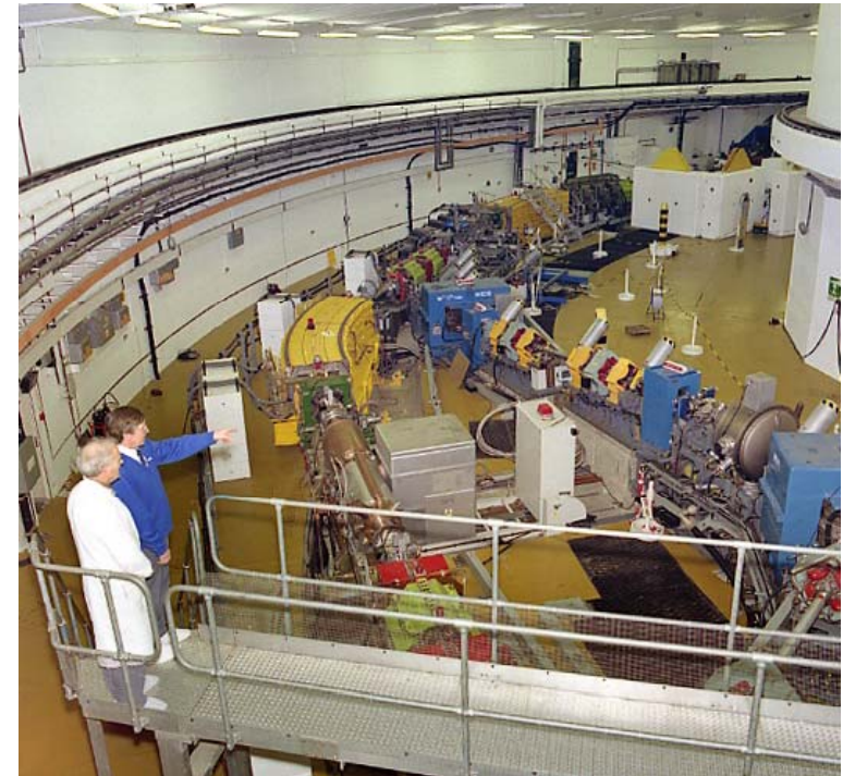
英国 STFC の ISIS シンクロトロン 加速エネルギー 800MeV ( \pi 中間子を作れます)
