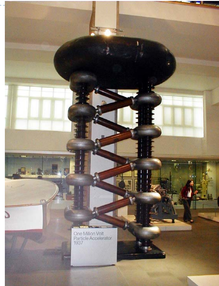
コッククロフトーワトソン型加速器 (1MeV) (National Science Museum, London)
