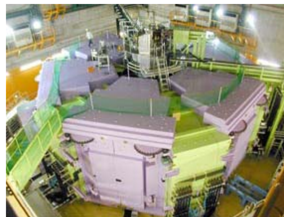
理化学研究所 RIBF のサイクロトロン 総重量 8300トン
