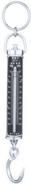
自然長 (力が働いてないときの長さ)からの「ずれ」を $x$ とする。この「ずれ」を元に戻そうとする力 $F$ は、 $x$ が十分小さいならば、近似的に $x$ に比例する。
